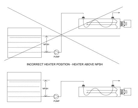
CORRECT HEATER POSITION - HEATER BELOW NPSH
